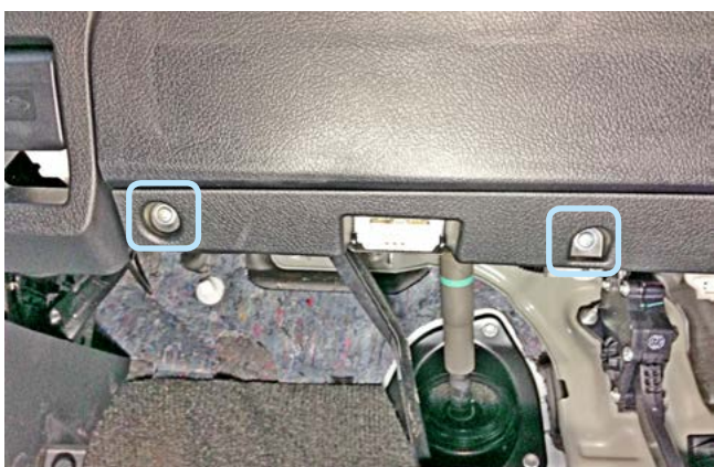
Фото 1.15. Саморезы крепления декоративной накладки под подушкой безопасности
