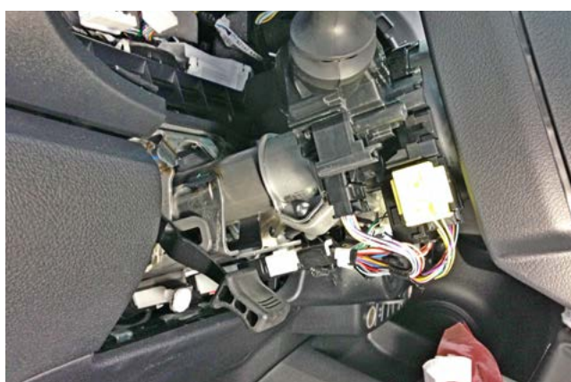
Фото 1.14. Кожух рулевого вала снят
