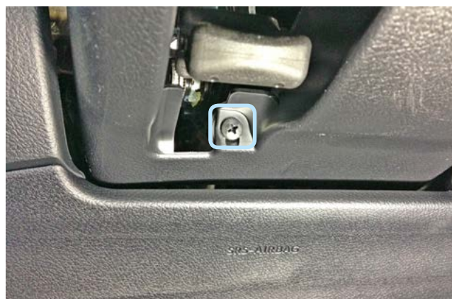
Фото 1.12. Саморез крепления кожуха рулевого вала снизу
