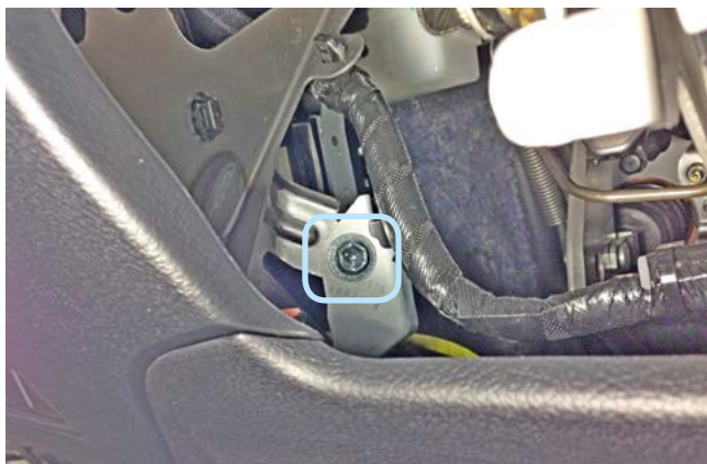
Фото 1.17. Болт крепления подушки безопасности вверху слева
