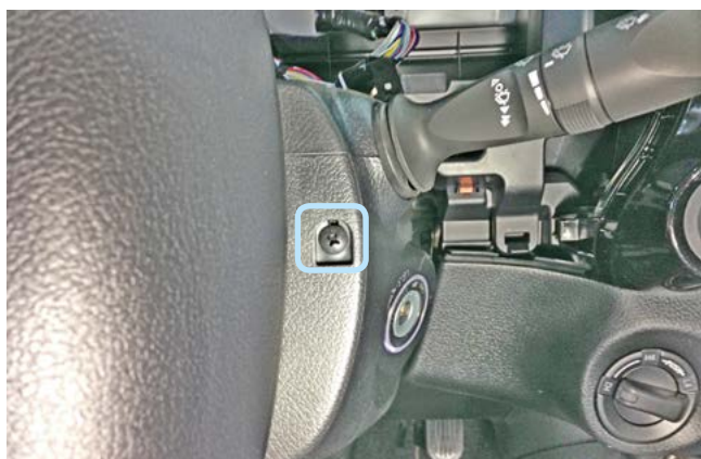
Фото 1.11. Саморез крепления кожуха рулевого вала справа
