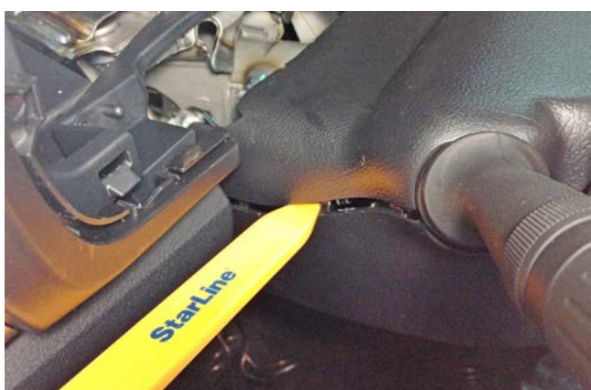
Фото 1.13. Разъединить верхнюю и нижнюю части кожуха рулевого вала
