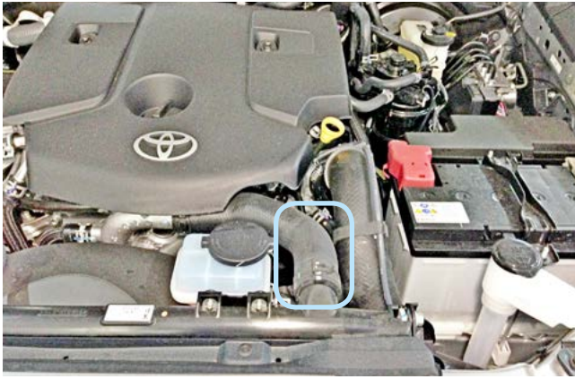
Фото 2.5. Место установки датчика температуры двигателя
