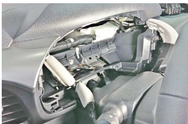
Фото 1.8. Панель приборов снята
