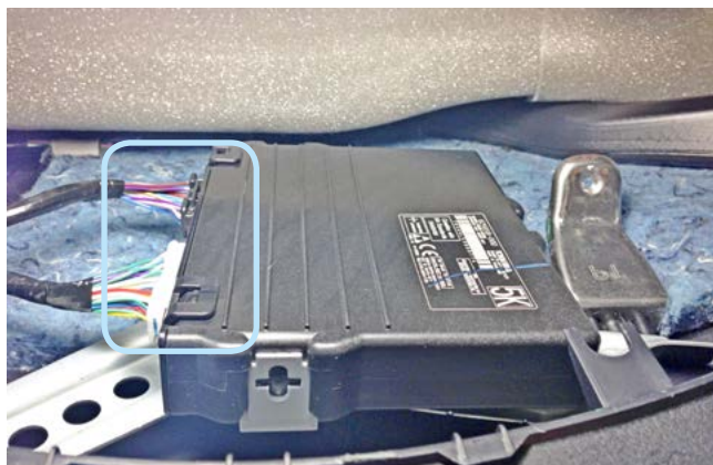
Фото 3.2. Местоположение блока сертификации. Разъёмы
