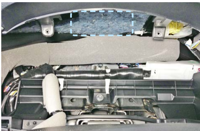
Фото 2.9. Пример расположения центрального блока охранно-телематического комплекса
