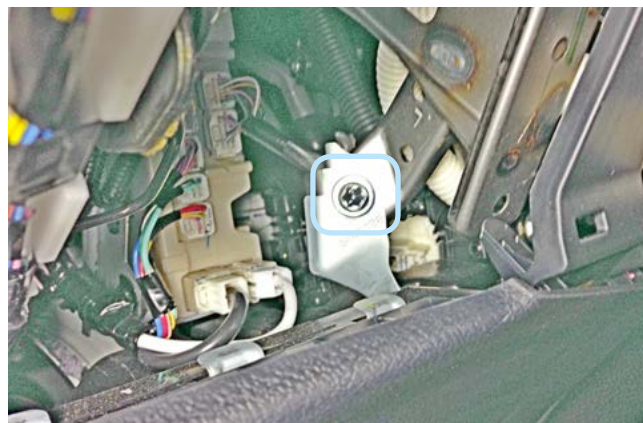
Фото 1.18. Болт крепления подушки безопасности вверху справа
