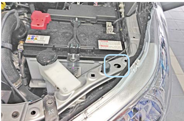
Фото 2.7. Возможное место установки концевика капота
