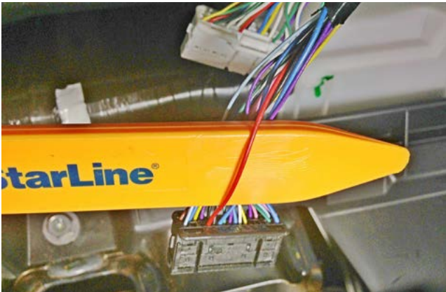
Фото 3.4. Разблокировка рулевого вала (красный)
