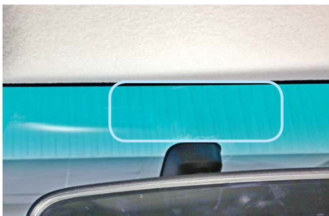
Фото 2.1. Возможное место установки антенного модуля
