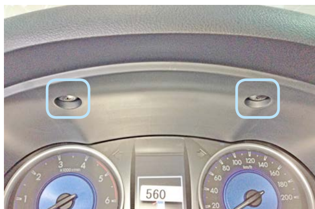
Фото 1.5. Клипсы крепления накладки панели приборов
