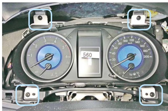
Фото 1.7. Саморезы крепления панели приборов
