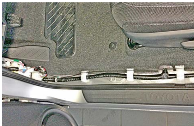
Фото 1.3. Накладки порога и кик-панели сняты
