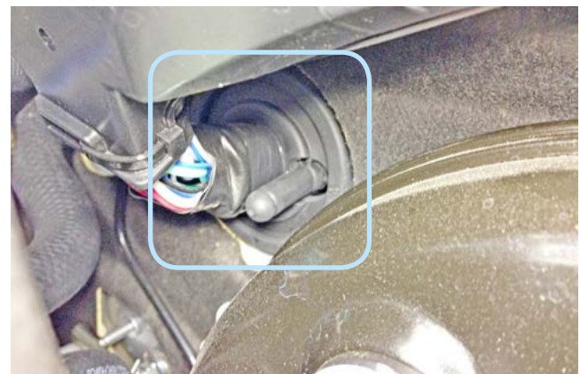
Фото 2.8. Штатный уплотнитель. Вид со стороны моторного отсека
