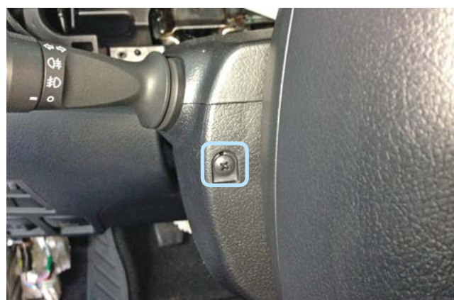
Фото 1.10. Саморез крепления кожуха рулевого вала слева
