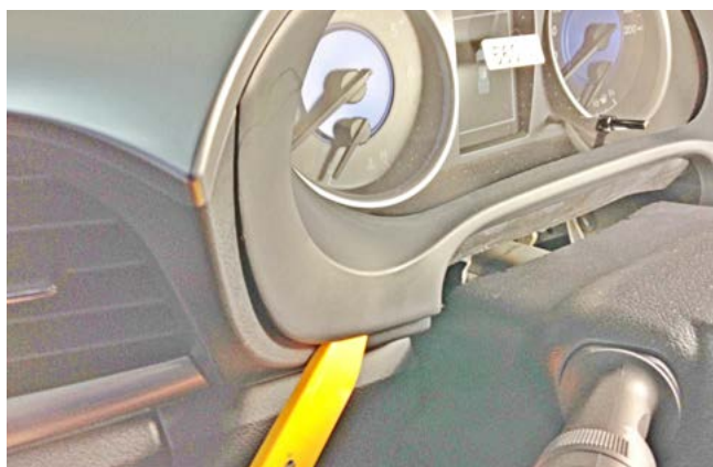
Фото 1.6. Снять накладку панели приборов
