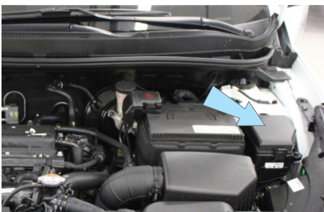
Фото 2.7. Возможное место установки подкапотного блока R6
