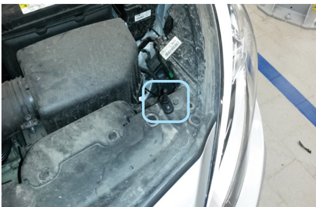
Фото 2.5. Возможное место установки концевика капота
