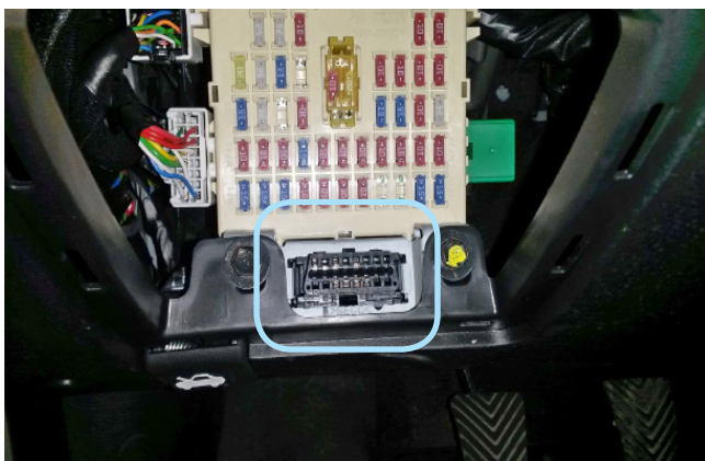
Фото 3.2. Местоположение диагностического разъёма
