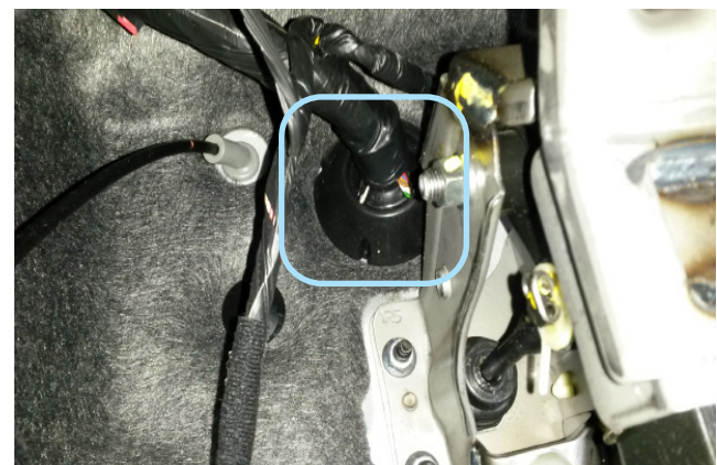
Фото 2.6. Штатный уплотнитель. Вид со стороны салона
