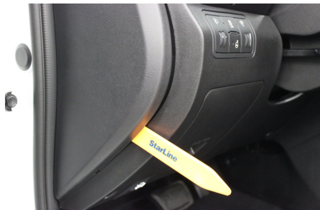
Фото 1.2. Снять левую боковую накладку передней панели
