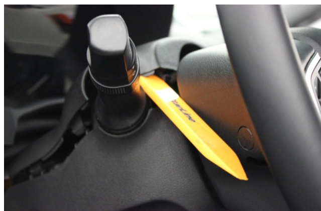
Фото 1.8. Снять верхнюю часть кожуха рулевого вала
