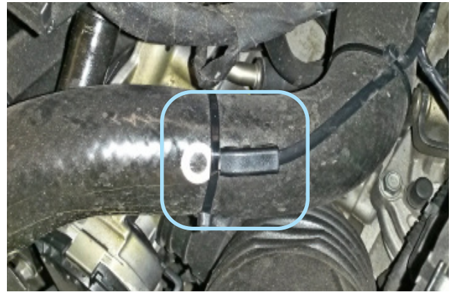
Фото 2.4. Крепление датчика температуры двигателя
