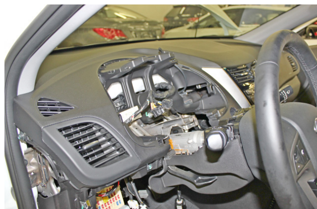
Фото 1.16. Панель приборов снята
