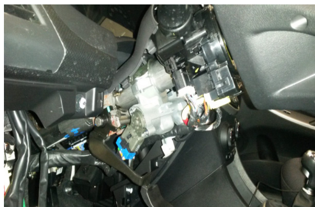
Фото 1.12. Кожух рулевого вала снят
