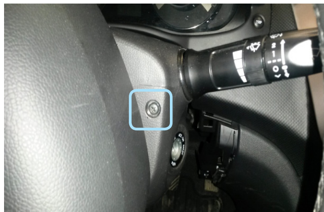
Фото 1.10. Саморез крепления нижней части кожуха рулевого вала справа
