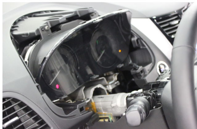
Фото 1.14. Накладка панели приборов снята
