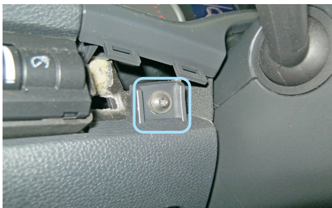
Фото 1.3. Накладка снята. Саморез
