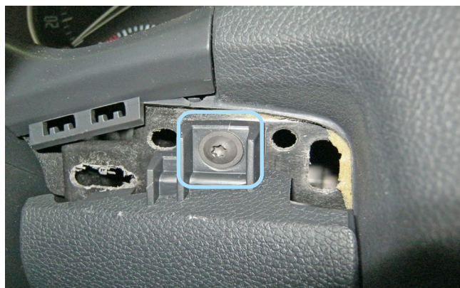
Фото 1.4. Накладка снята. Саморез
