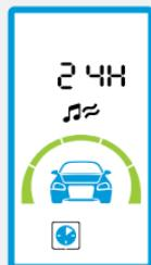
**3** | Нажмите кнопку 1 длительно (до звукового сигнала) или дождитесь автоматического (через 4 сек.) сохранения выбранного периода автозапуска:
