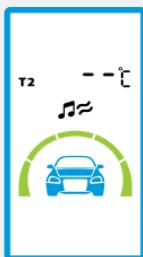
Если температура ниже - 40°C или датчик не подключен, то индикация отсутствует.
