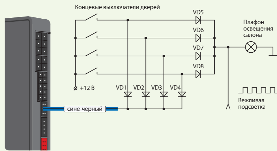
Схема диодной развязки для положительной полярности концевиков дверей
