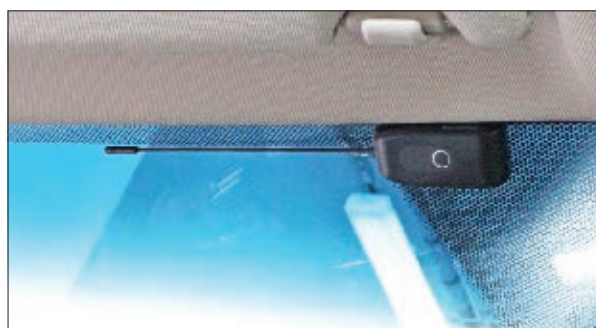
Модуль приемопередатчика на шелкографии
