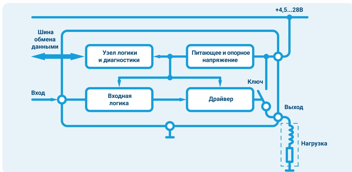
Типовая структурная схема интеллектуального ключа
