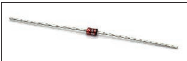
Миниатюрный стабилитрон в стеклянном корпусе
