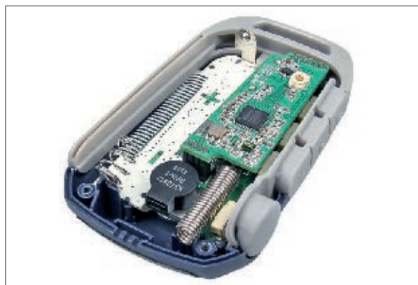
Пример встроенной в брелок антенны
