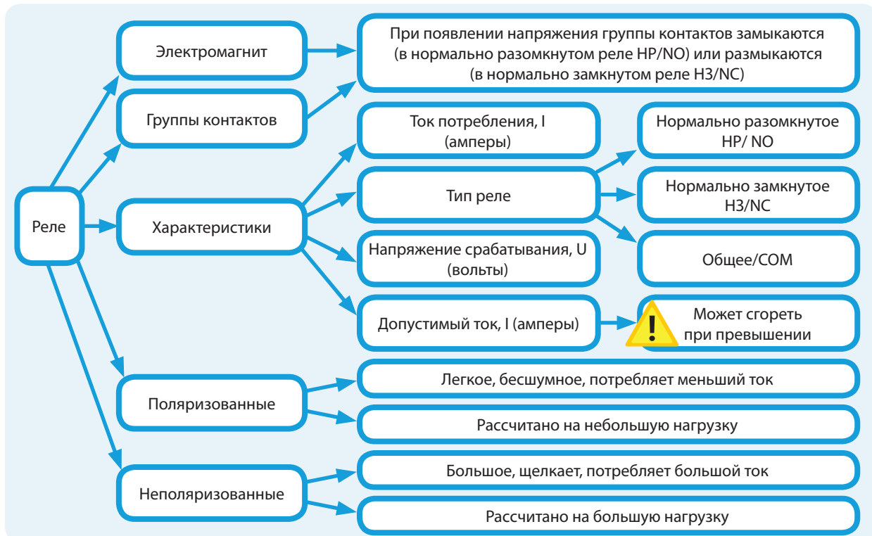
Реле. Схема-памятка
