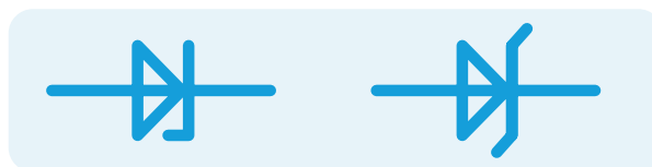
Условное изображение стабилитрона на «наших» и «импортных» схемах
