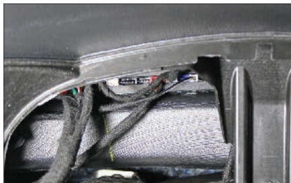
Крепление блока охранного комплекса
