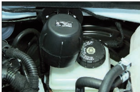
Сирена, перекрывающая крышку бачка
