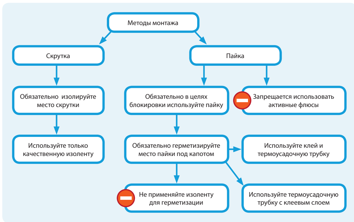
Методы монтажа. Схема-памятка
