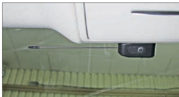
Модуль приемопередатчика на чистом лобовом стекле
