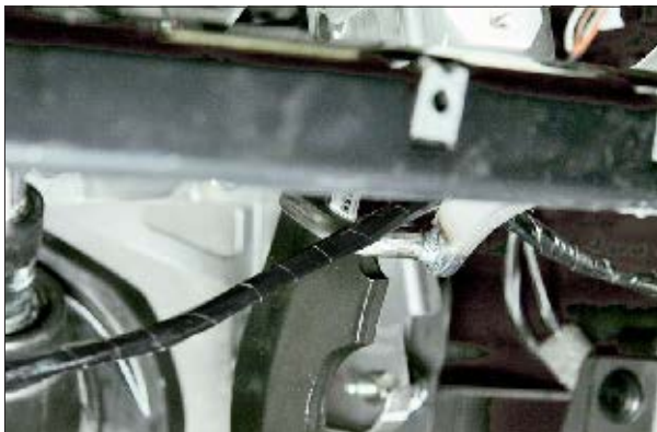
Низкое качество установки охранного комплекса: провода не закреплены
