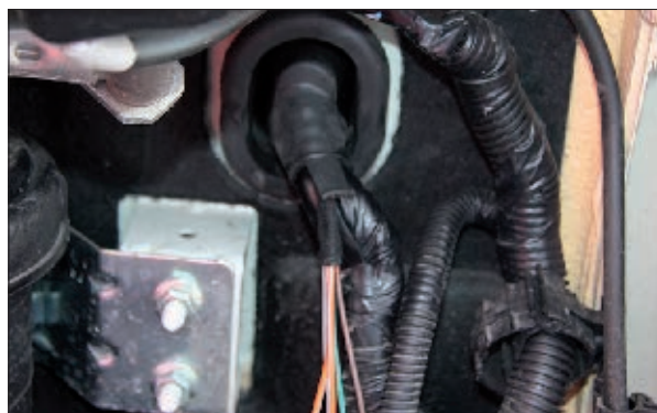
Проложенный через штатное отверстие жгут
