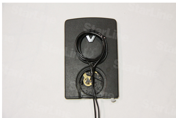
Фото 8.3. Расположение изготовленной рамки обходчика VP-03 на ключ-карте
