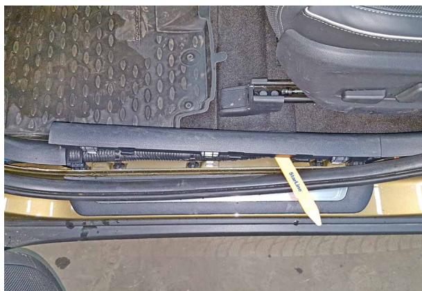
Фото 1.3. Снять накладку порога двери водителя
