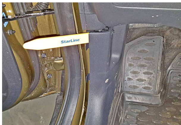
Фото 1.5. Снять накладку левой кик-панели
