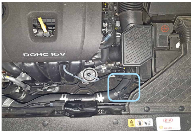
Фото 4.3. Место установки датчика температуры двигателя
