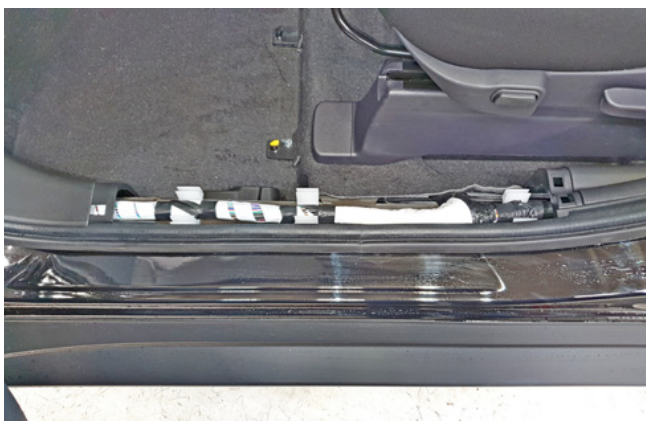
Фото 1.3. Накладка порога двери водителя снята
