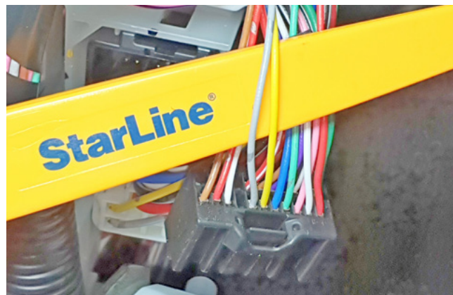
Фото 3.7. Управление центральным замком (серый и жёлтый)
