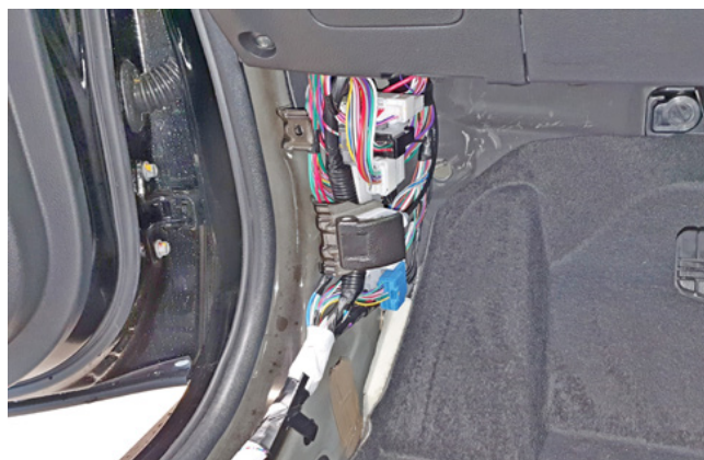
Фото 1.6. Накладка левой кик-панели снята
