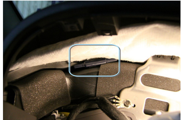
Фото 8.4 Антенна за приборным щитком
