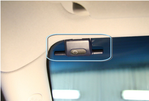
Фото 8.3 Антенна на лобовом стекле
